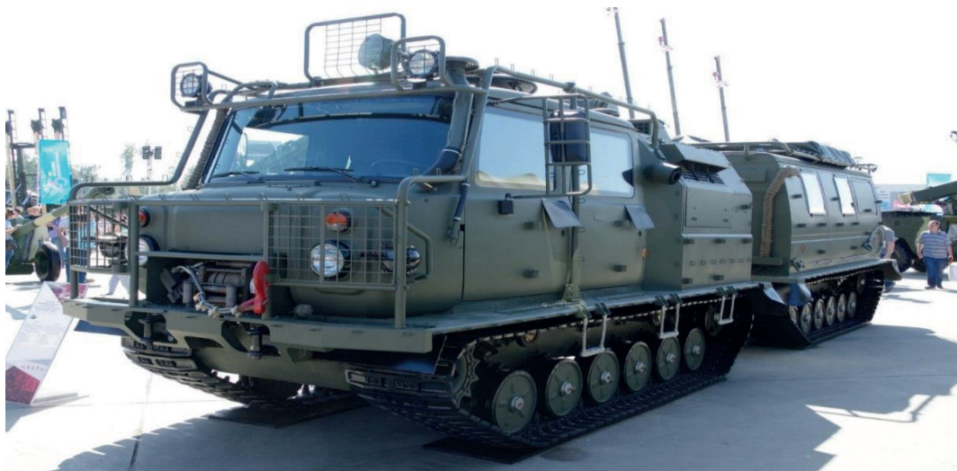
Рисунок 1 - Двухзвенный гусеничный транспортер-тягач ГАЗ-3344 «Алеут» как база для монтажа КШМ Р-142Т
