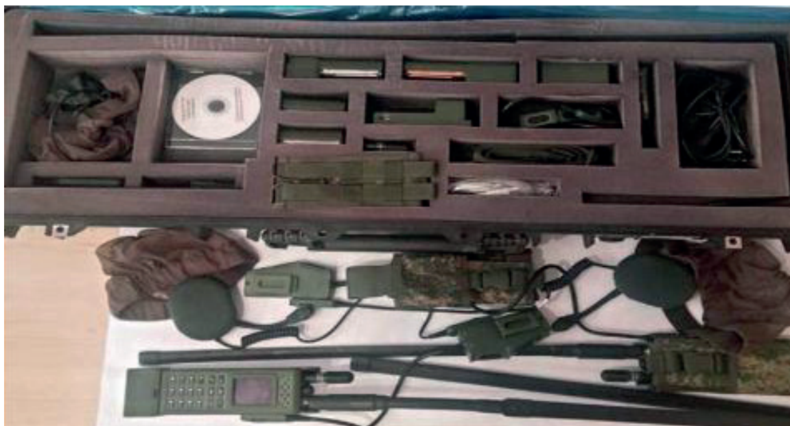
Рисунок 2 - Комплектность радиостанции Р-187П1Е «Азарт»
